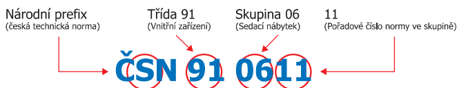
Obrázek 16: Klíč k označení a názvu původní ČSN podle třídícího znaku
